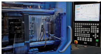
Moulage par injection sous flux laminaires.
