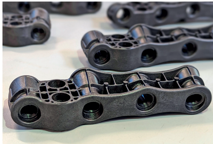
Exemple de pièces industrielles à haute technicité chargée fibres de carbone.
